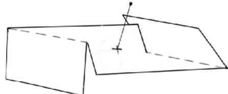
5. Propeller auf die Motorachse stechen
