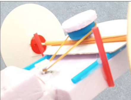
Fernsteuerung für den Flitzer Ein Gummiband überträgt die Lenkbewegung vom Motor auf die Vorderachse.
